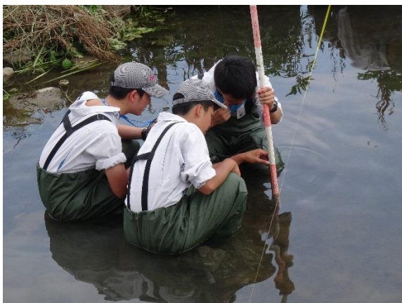
流速計で測定中。 流速と断面積から流量測定
