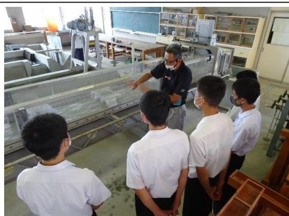
水理実験中。橋脚の形状により水の動きに変化が。
