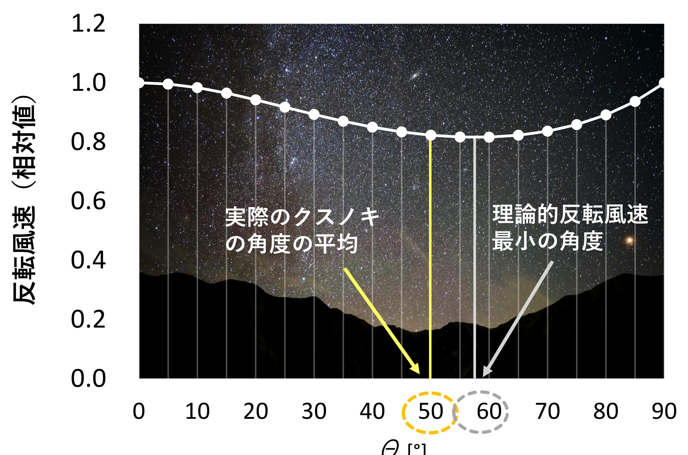
図9 長方形モデルにおける表葉の角度と反転風速の関係
