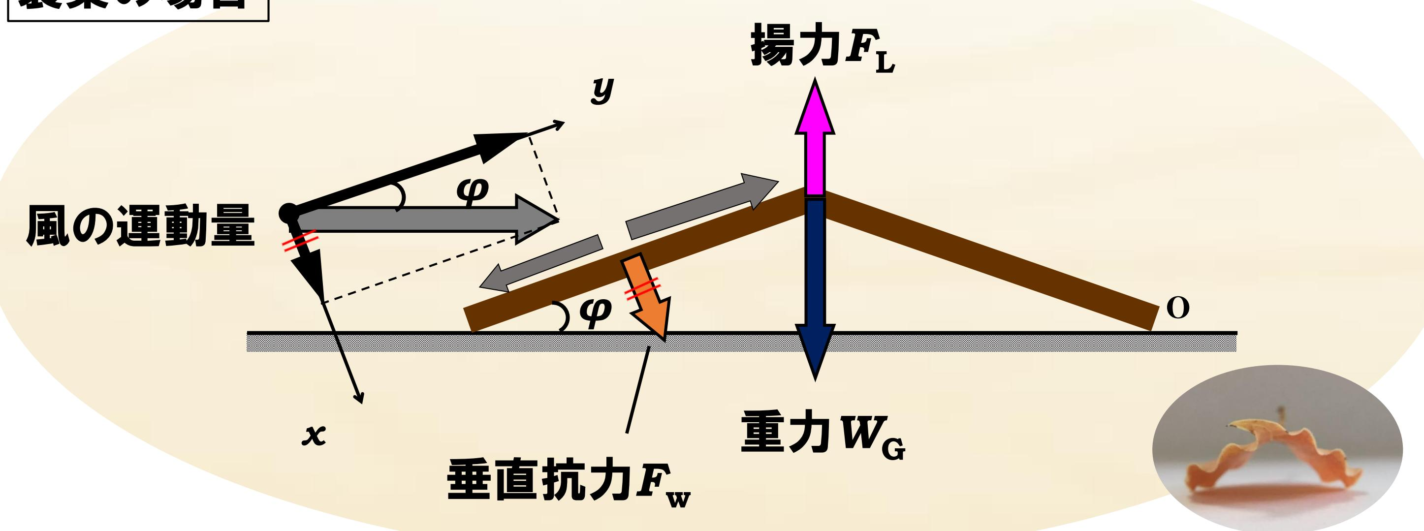
図7 風により生じる垂直抗力と揚力
