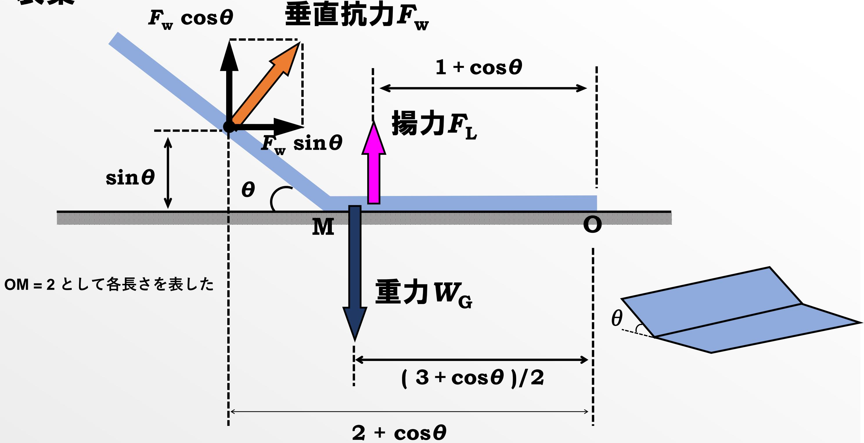
図8 落ち葉の長方形によるモデル化
