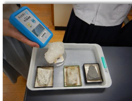
写真 左上：研修のようす 左下：放射線量測定器で石を測定
