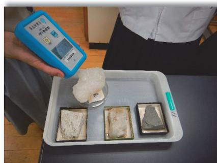
左下：放射線量測定器で石を測定
