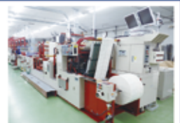
▲印刷機 MST-7 号機 最大印刷長 300 寸 (約 8m) 6 色機
